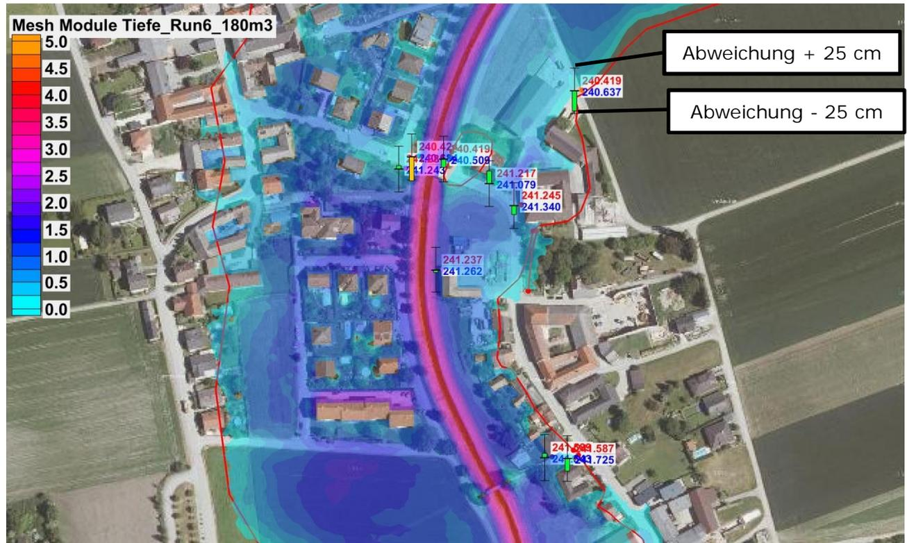
Abbildung 19: Nahbereich Pegel: Vergleich gerechnet-gemessen: gerechnete Wassertiefen bei  $180 \text{ m}^3/\text{s}$ , rekonstruierte Anschlaglinie (rote Linie). Symbole: Vergleich gerechnet-gemessen an den Hochwassermarken (grüne Balken: Abweichung  $< \pm 25 \text{ cm}$ , roter Text: gerechnete Wasserspiegel, blauer Text: Wasserspiegel Marke), mit den schwarzen Linien ist eine Abweichung von  $\pm 25 \text{ cm}$  begrenzt.
